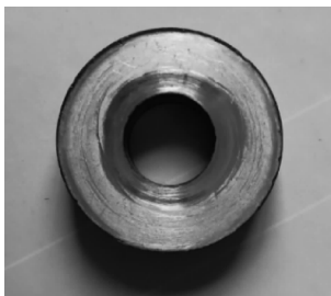
图2 压电片镀银层损坏
